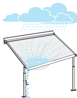
Bei Überschreiten der Regenklasse 2 (56 l/h/m²) muss die Plaza Viva zwingend eingefahren werden. Beschädigungsgefahr!
